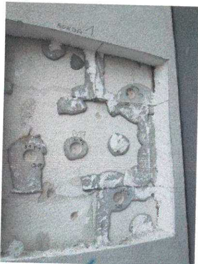
foto /35/ Sonda 1 ze zkoušky přídržnosti ([4])
