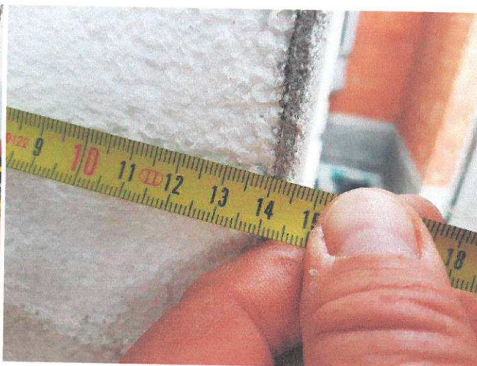
foto /12/ Detail základní vrstvy z foto /11/ - tloušťky 1,5 mm
