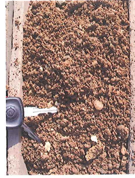
Foto 6: Terasové sedimenty - slabě zahlíněné hrubozrnné písky s příměsí drobného šterku J2, 6,5-6,7 m
