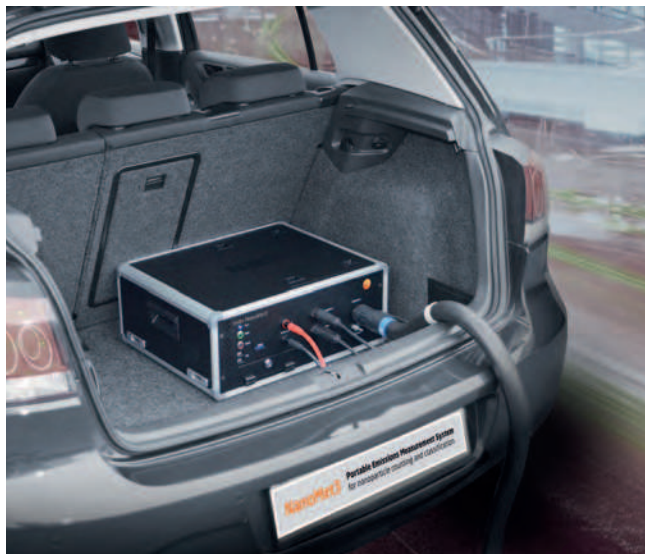
Využití testu NanoMet3 pro silniční zkoušku (RDE).
